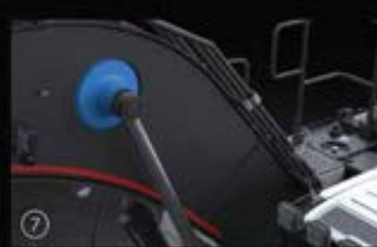
⑦ Cojinete del cilindro de la pluma de fundición reforzado
