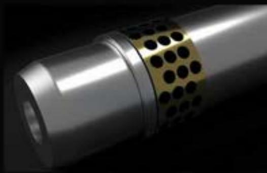
Los casquillos utilizados en los puntos de conexión pluma-balancín y pluma-chasis, llevan incrustado en la estructura interna partículas de bronce-grafito y permiten ampliar los plazos de lubricación y minimizar el desgaste de los bulones gracias al grafito, un material con una capacidad de absorción y retención de la grasa muy alta.
